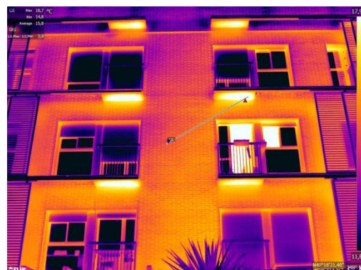
OBRA 2 Móstoles (Madrid). Fachada AUTOPORTANTE de ladrillo cara vista. AUSENCIA de puentes térmicos en los frentes del forjado.
